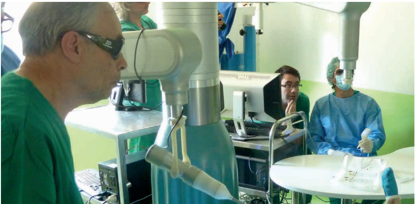
El robot quirúrgic Bitrack operant en un quiròfan experimental, dins del conjunt de proves que cal fer per obtenir el certificat de la Comunitat Europea (CE)
